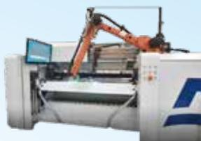
印刷プレートを最高の精度で行えるように設計されたマウンターです
